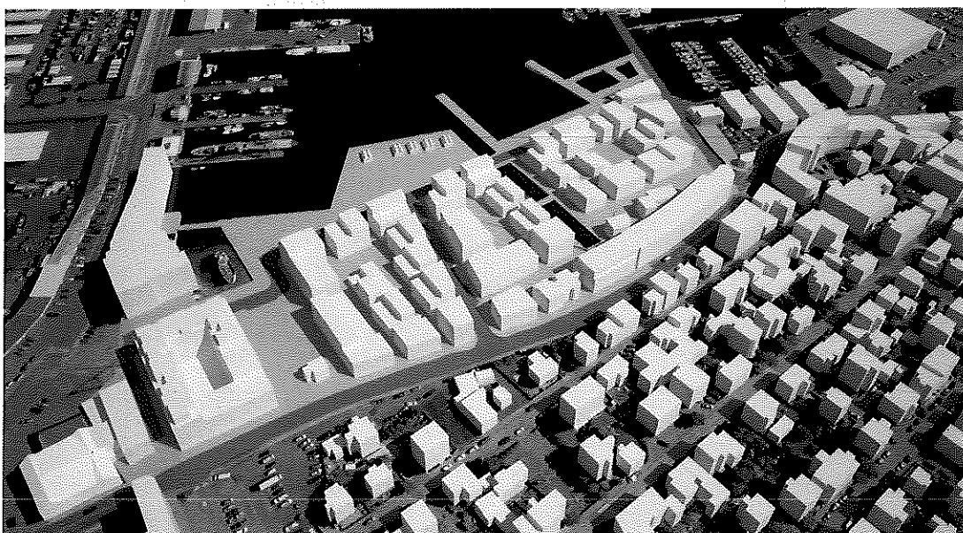
Skýringarmynd, Áfangi 1 +2 – Bygðamynstur ; model af núverandi byggð sýnir flata kassa m.v. hæsta kóta.
