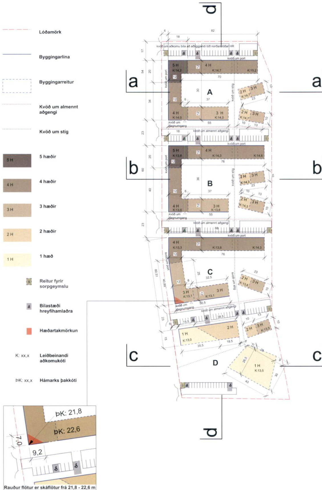
Mynd 23 Skilmálateikning. Grunnmynd. Lóð háskólagarða HR.
