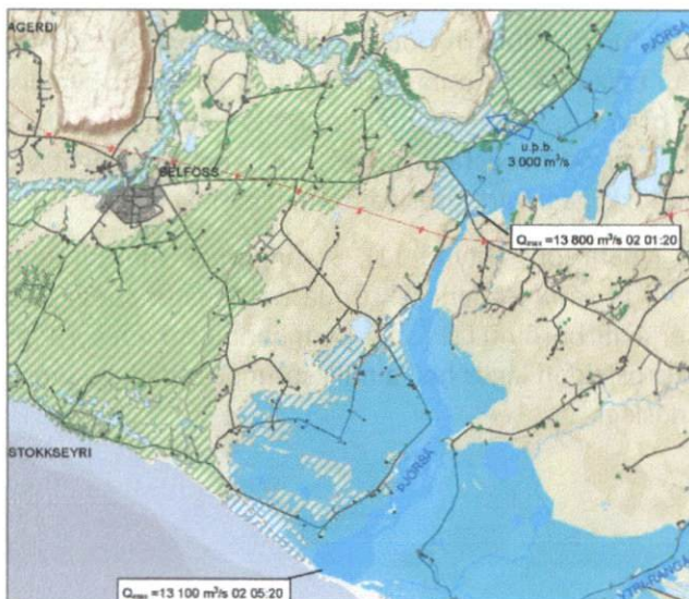
Mynd 12. Mesta útbreiðsla flóðs í Þjórsá vegna mögulegs eldgoss í Bárðarbungu. Bláa svæðið sýnir mestu útbreiðslu, blátt skástrikað svæði sýnir óvissa útbreiðslu og grænt skástrikað svæði sýnir útbreiðslu áætlaða út frá sögulegum flóðum 1825-2006.
