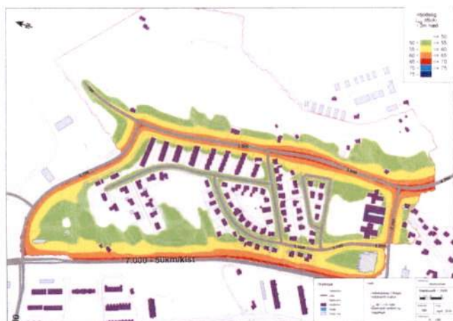
Mynd 9. Hljóðstig m.v. núverandi byggð og núverandi umferðarmagn.
