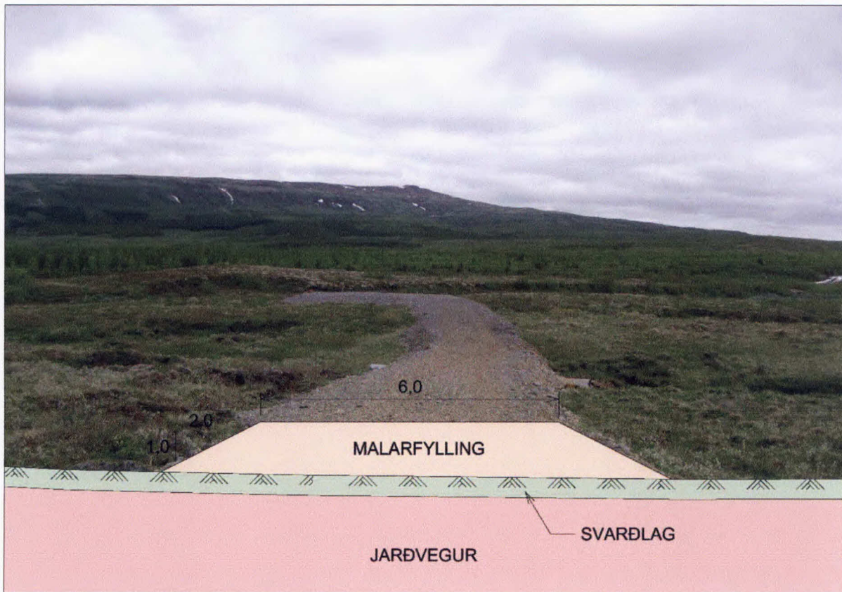
Mynd 6 Gerð og frágangur vega á framkvæmdasvæði Brúarvíkjúnar.
