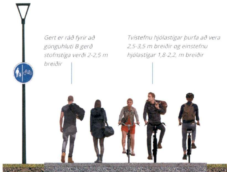
Mynd 31.15 Sníð af uppbyggingu á aðgreindum stofnstíg af B gerð.
