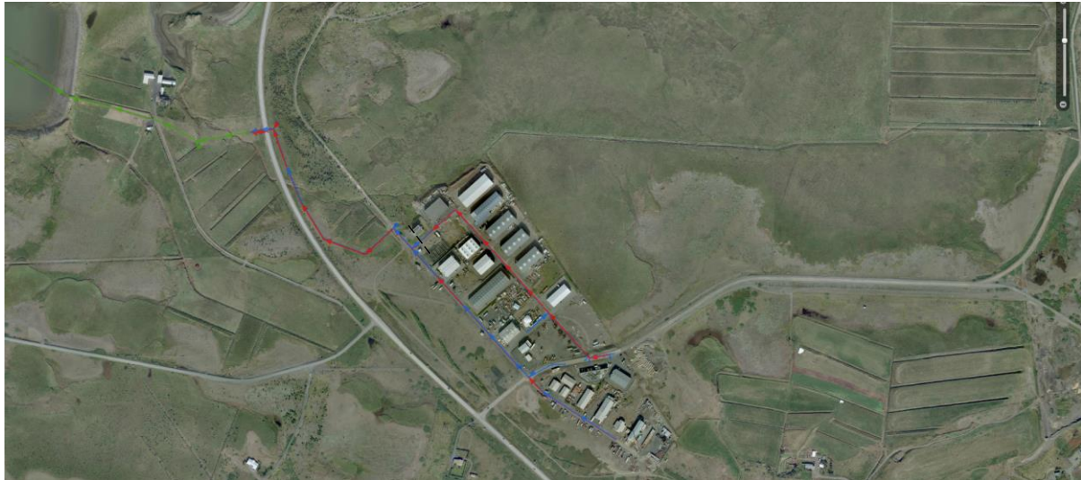
Mynd 12: Núverandi fráveitulagnir á uppbyggða athafnasvæðinu á Esjumelum. Rauður litur táknar skólplagnir, blár ofanvatnslagnir og grænn er sameiginleg lögn skólps og ofanvatns (mynd fengin af lukor.or.is).
