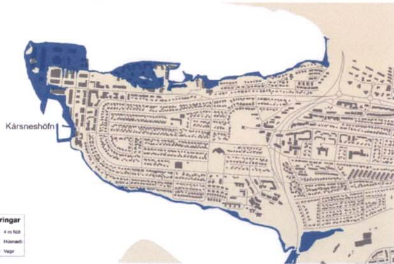
Mynd 5-30. Möguleg sjávarflóðasvæði í Kópavogi miðað við 4 m flóð. Heimild: Skýrsla VSÓ, kafla 5.5.2. http://www.skiplag.is/media/pdf-skjol/Haekud-sjavarstada-a-hofudborgarsvuedinu-ahrif-og-adgerdir.pdf
