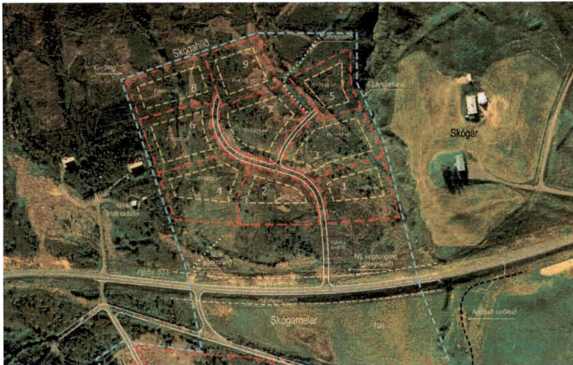
Myndin sýnir vesturhluta deiliskipulags frístundabyggðar að Skógum (norður er til hægrri). Rauðar brotalínur eru lóðamörk en gular sýna byggingarreiti.
