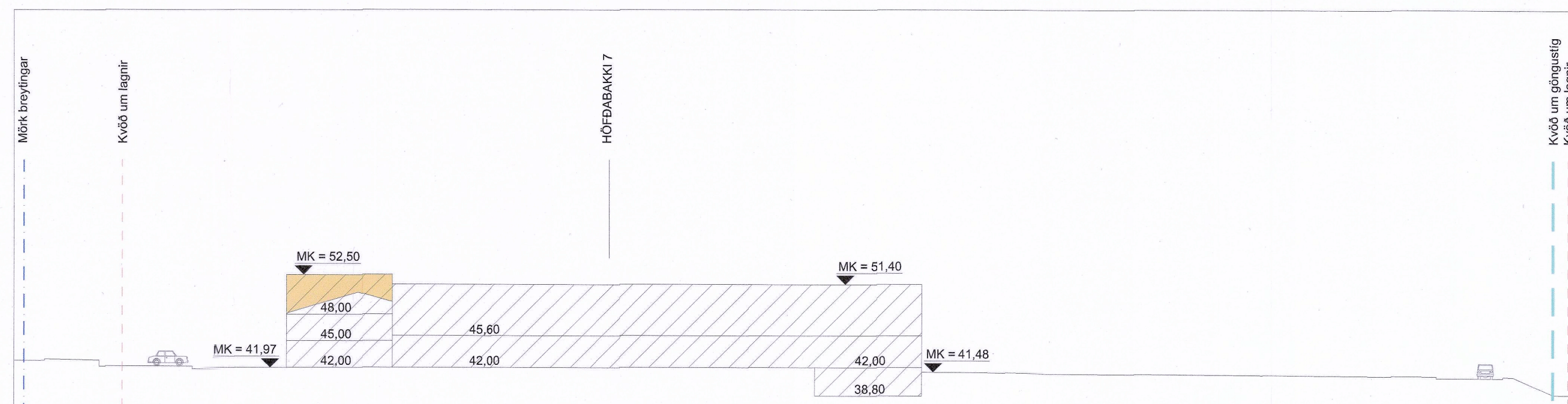
Eftir breytingu: Hæð bætt ofan á vestanverðan hluta Höfðabakka 7. Sníð B-B, 1:500 (prentað á A1)
