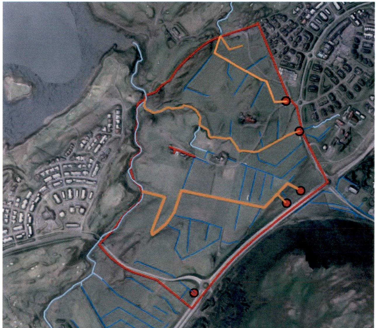
Farvegir og meginrennislíleiðir (gular línur) í gegnum Blikastaðaland. Ræsi sem veita vatni inn á Blikastaðalandið eru sýnd með rauðum punktum og bláar línur sýna skurði. Mikilvægustu rennislíleiðir vatns á svæðinu eru Úlfarsá, Skáltúnslækur og skurðir sem flytja yfirborðsvatn sem kemur undan Vesturlandsvegi af Úlfarsfelli.
