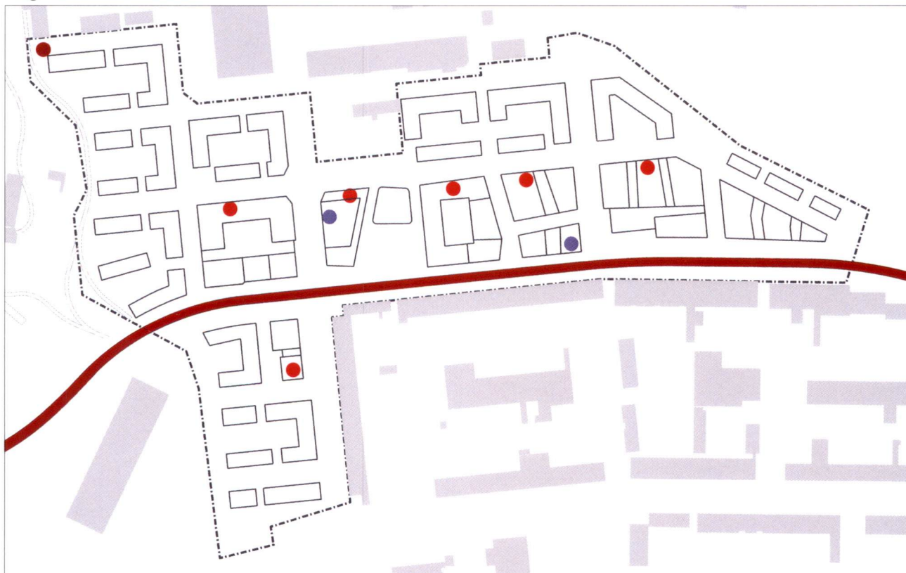
Dreifistöðvar rafmagns Fyrirhuguð dreifistöð rafmagns ●
