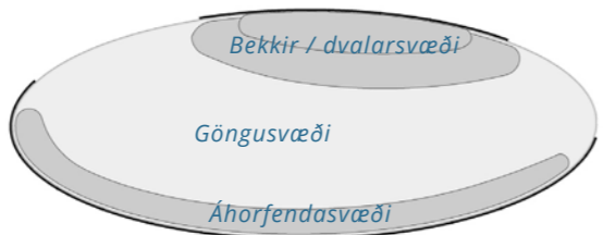
Mynd 8.7 Dæmi um skipulag útsýnispalls með sporöskjulaga grunnformi. Sporaskjan bíður upp á langar hliðar til að njóta útsýnis og hentuga stærð á göngu- og bekkjarsvæði.
